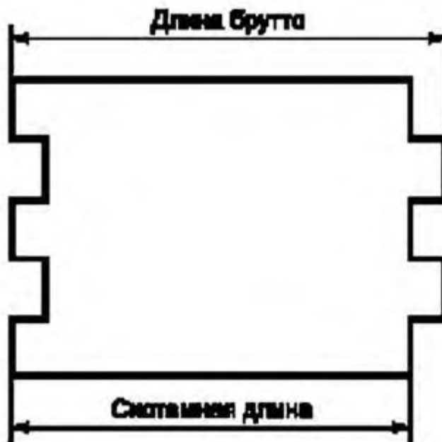
«Рисунок А. 1 - Размеры изделий с пазогребневым соединением»
