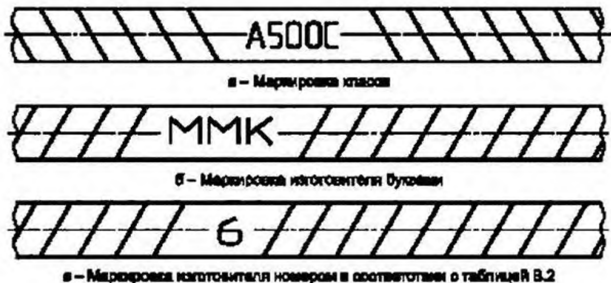
Рисунок В.1 - Маркировка проката надписью
