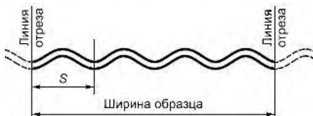
Рисунок 19 - Схема обрезки целых листов перед испытанием
