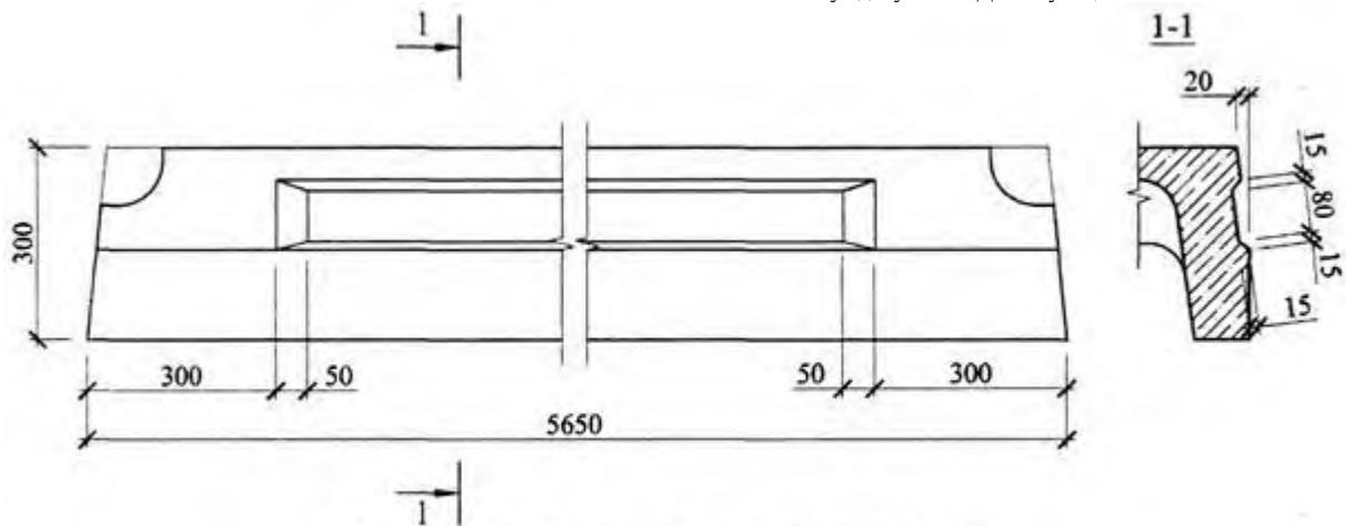
Рисунок 1 – Углубление на боковой поверхности плиты
