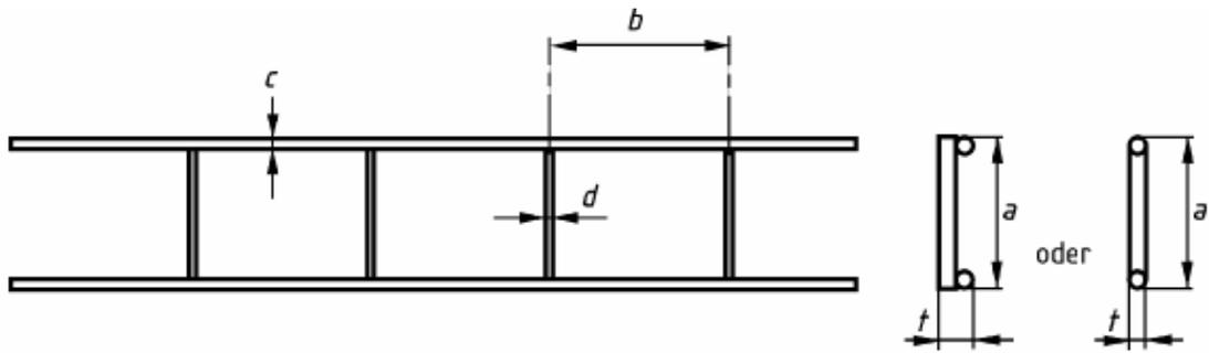
Рисунок 5.3 Пример арматуры решетчатого типа – вид сверху и вид в разрезе
