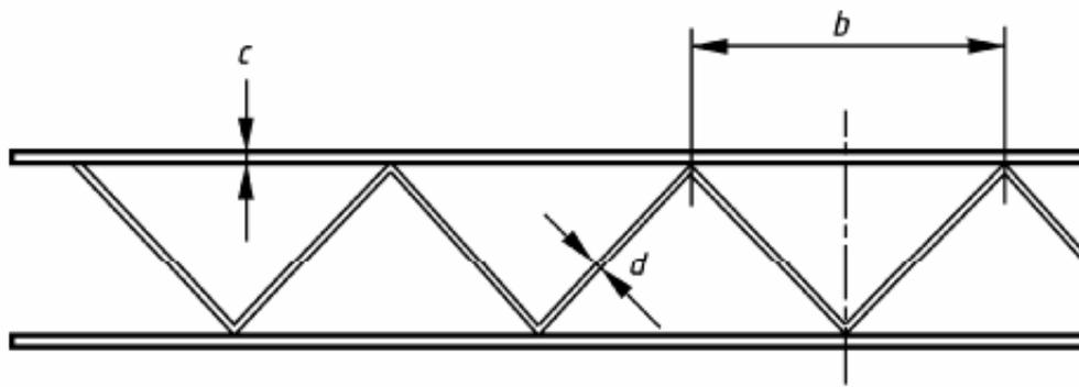
Рисунок 5.4 Пример арматуры фахверкового типа – вид сверху
