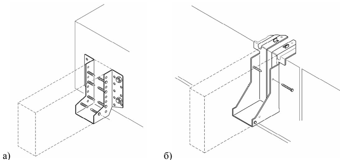
а) Приспособление для укладки бруса, балки, фермы или стропила на стене из каменной кладки с помощью крепежных болтов или винтов (плоскостное закрепление).
