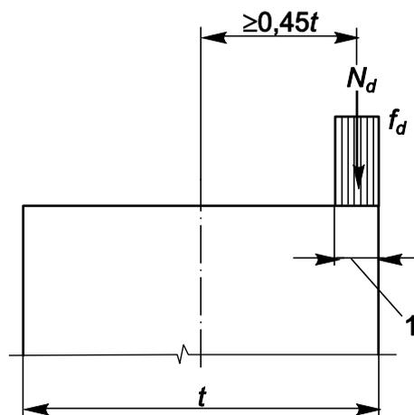
1 — расчетная длина опоры не более  $0,1t$ , вычисленная по узловым моментам жесткого узла
