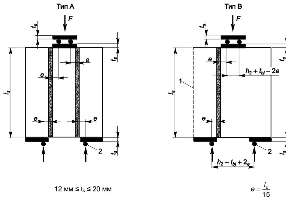
1 – распил; роликовая опора диаметром 12 мм, установленная жестко или с силовым креплением.
