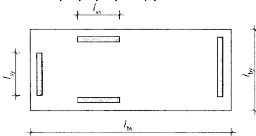
Рисунок 9.35 Расположение стен жесткости в плане
