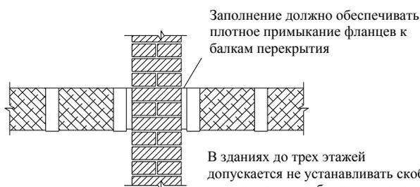
В зданиях до трех этажей допускается не устанавливать скобы, при условии, что балка надежно связана с фланцем.
