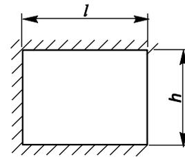
— шарнирное опирание (без жесткого закрепления);
