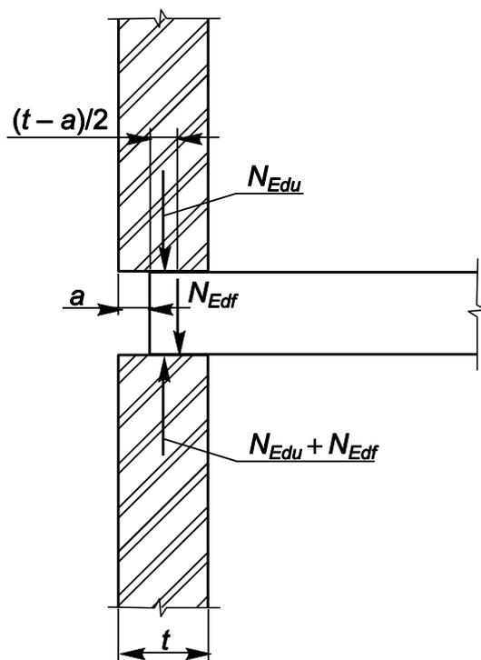
Рисунок 8.5 Усилия в зоне узла плит перекрытия, частично опирающихся на стену
