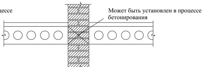
**Рисунок 11.13 Соединения конструкций перекрытий с внутренними каменными стенами**
