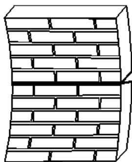
а) Неперевязанное сечение. Плоскость излома параллельна горизонтальным швам,  $f_{xk1}$
