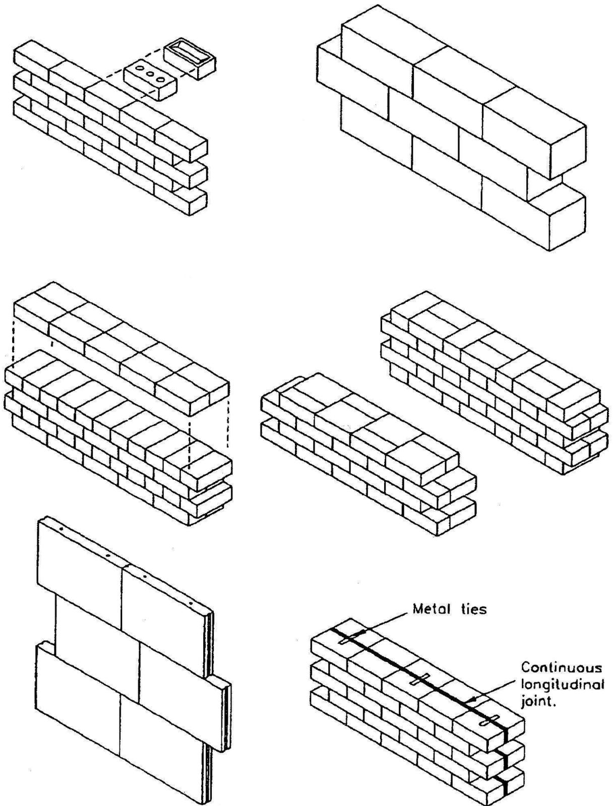
Рисунок 11.2 Примеры перевязок каменных кладок с использованием кирпича 1 группы.
