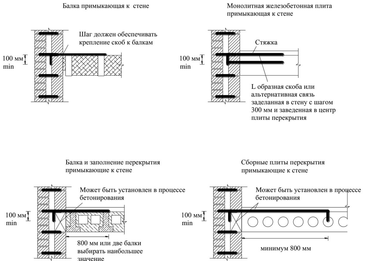
При установке скоб для крепления к перекрытиям и стенам в местах несовпадения швов кладки с поверхностью пола, необходимо взламывать кирпичную кладку
