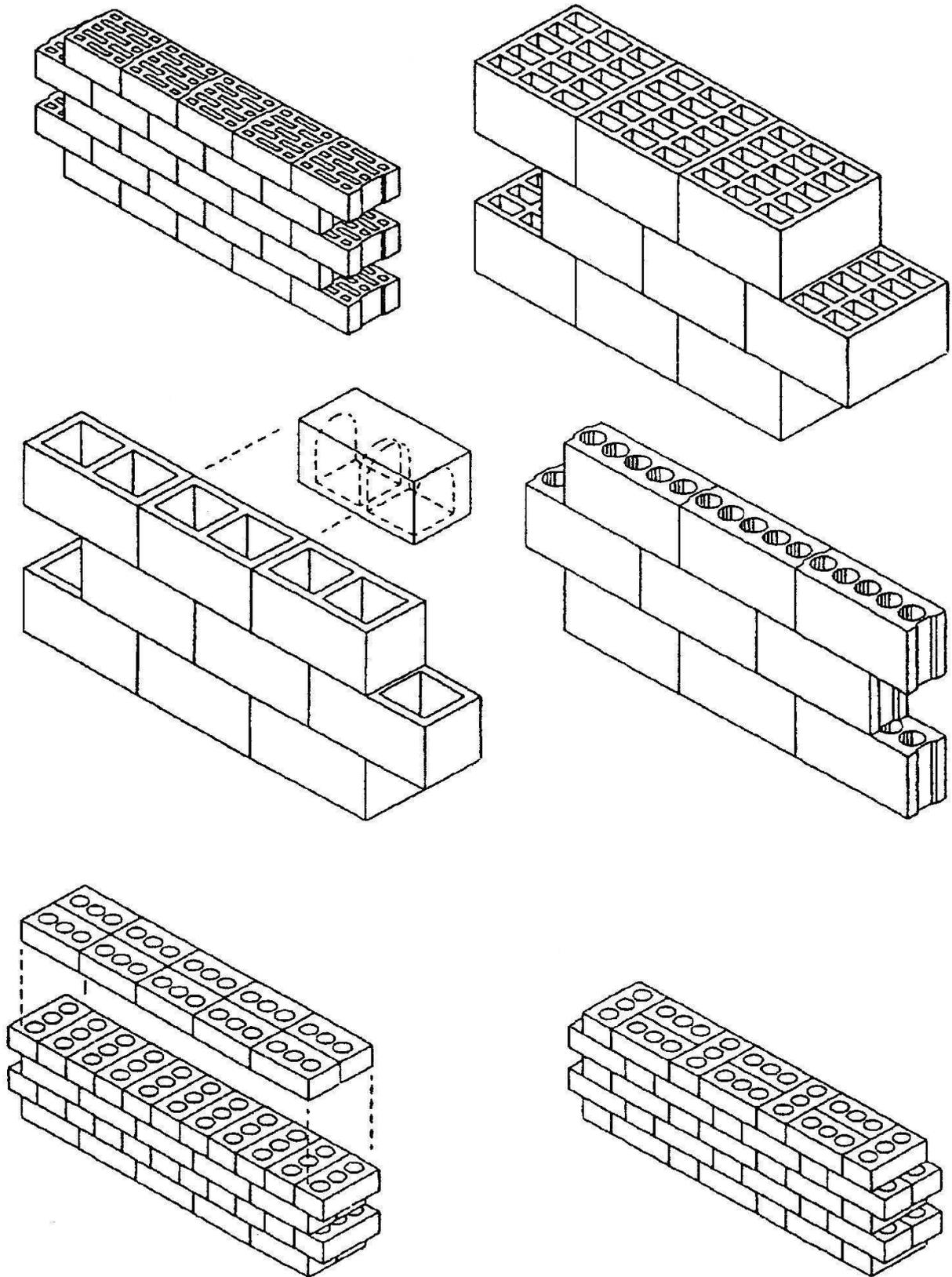
Рисунок 11.3 Примеры перевязок каменных кладок с использованием кирпича группы 2а и 2б
