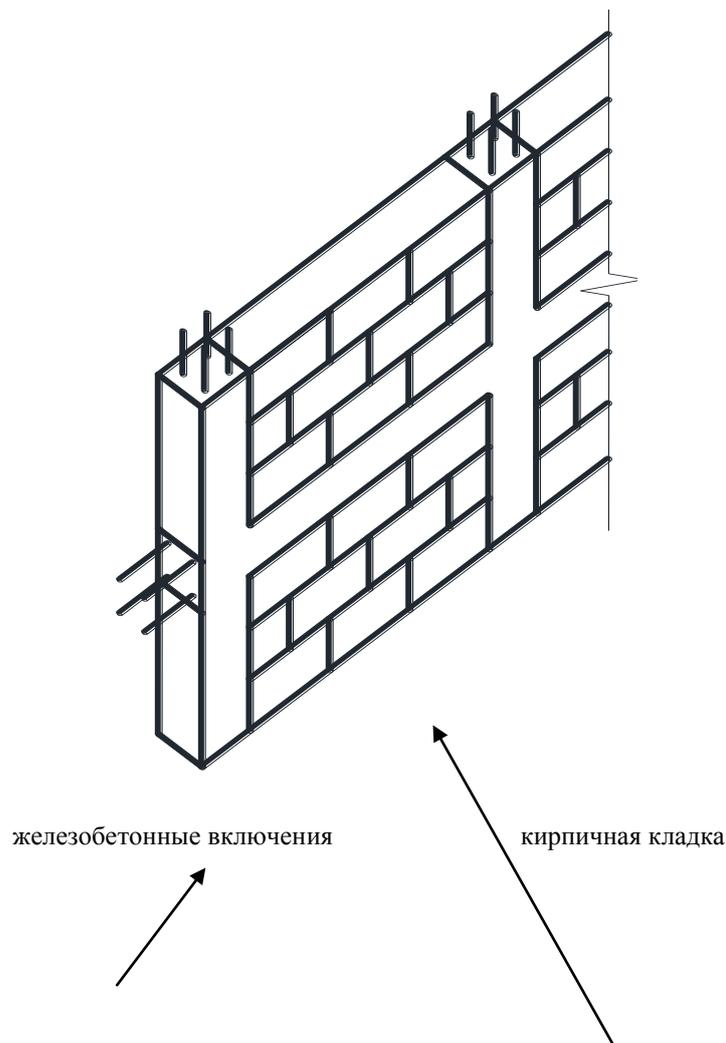
**Рисунок 11.9 Комплексная конструкция**
