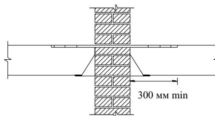
В зданиях до трех этажей допускается не устанавливать скобы, при условии, что балка надежно связана с фланцем.
