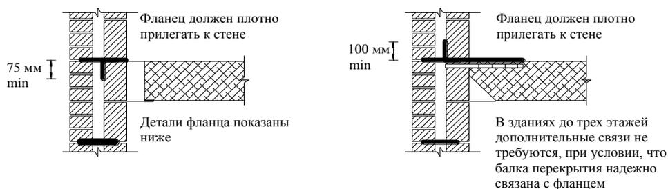
**Рисунок 11.10** Опирание деревянных балок перекрытия на кирпичную стену с одной стороны
