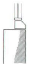
d) водосливный порог без выступа (бесфланцевый водосливный порог)
