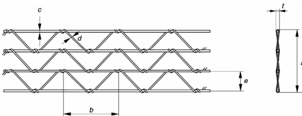
Рисунок 5.5 Пример стальной плетеной сетки – вид сверху и вид в разрезе
