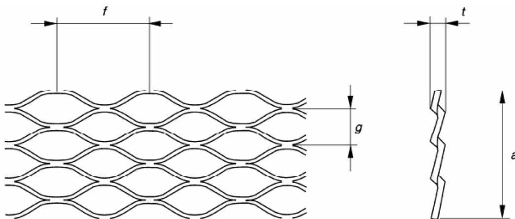
**Рисунок 5.6** Пример просечно-вытяжной сетки - вид сверху и вид в разрезе
