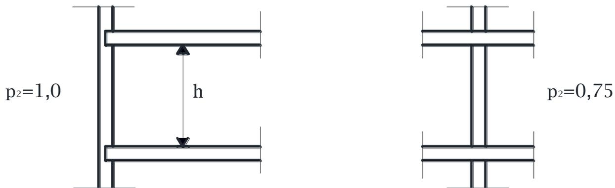
**Рисунок 9.16 Жесткое защемление перекрытиями и конструкциями крыши**
