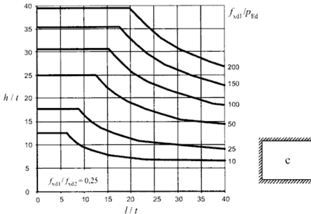
**Рисунок 9.33** Предельная толщина и размер несущих стен горизонтальной (боковой) нагрузкой. Тип с стены —  $f_{xd1}/f_{xd2} = 0,25$
