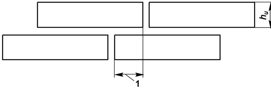
1 — размер перевязки. Если  $h_u$  не более 250 мм — размер перевязки не менее  $0,4h_u$  или не менее 40 мм.
