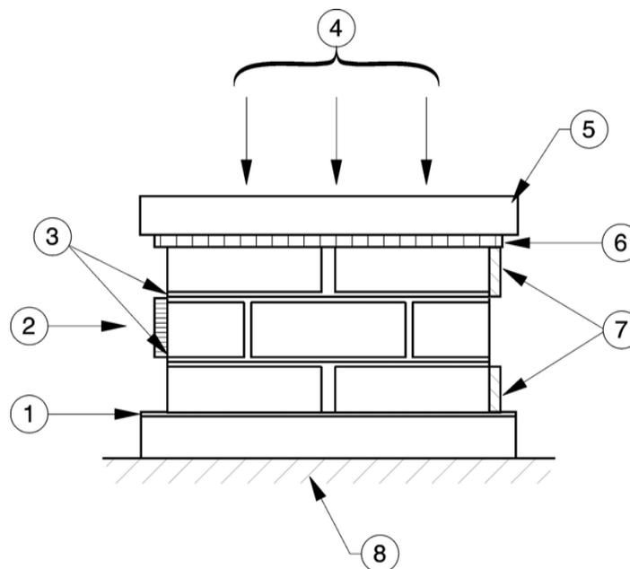
1 целлюлозная папка; 2 усилие сдвига; 3 гидроизоляционный слой; 4 сжимающая нагрузка; 5 верхняя нажимная плита; 6 грузораспределительный материал; 7 жесткие контропоры для закрепления верхних и нижних слоев (регулируемые для учета небольших различий в кладке); 8 нижняя нажимная плита
