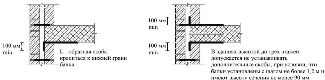
Опираие деревянных балок перекрытия на каменную стену с использованием фланцев
