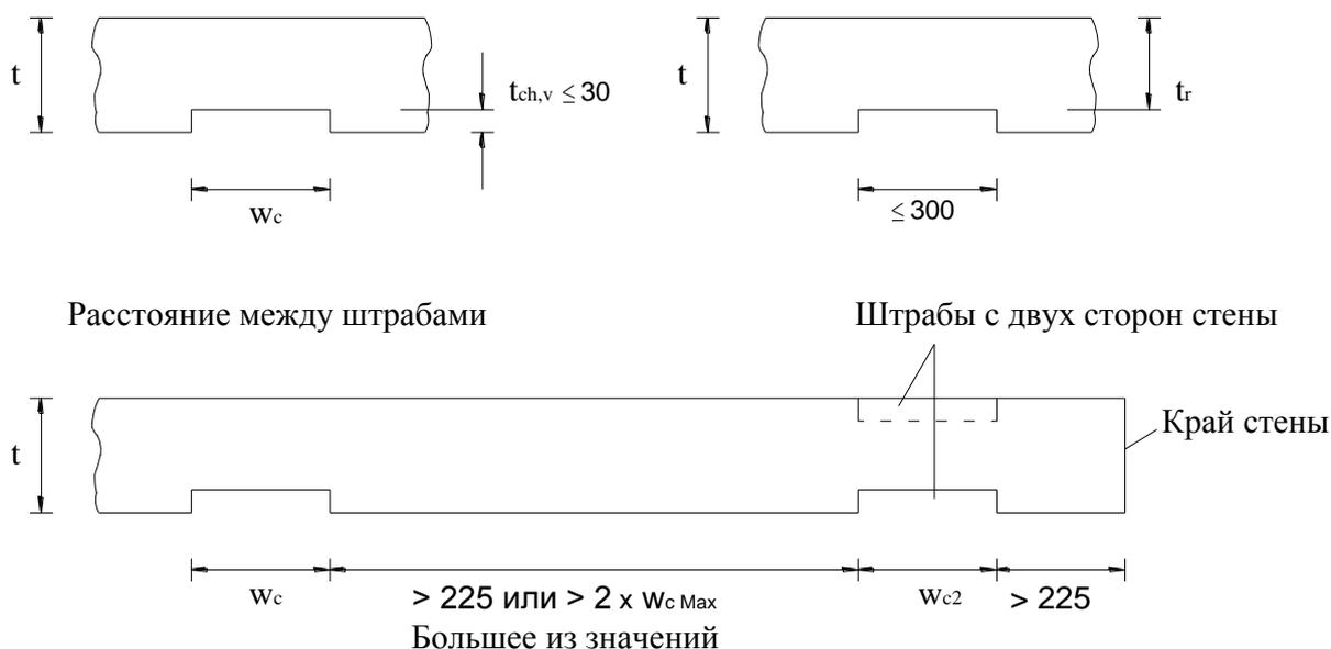
Штрабы в основании стены толщиной  $\geq 225$  мм
