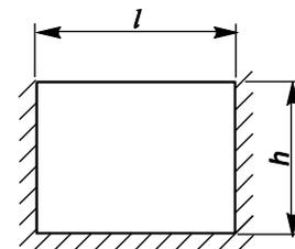
— шарнирное опирание (без жесткого закрепления);
