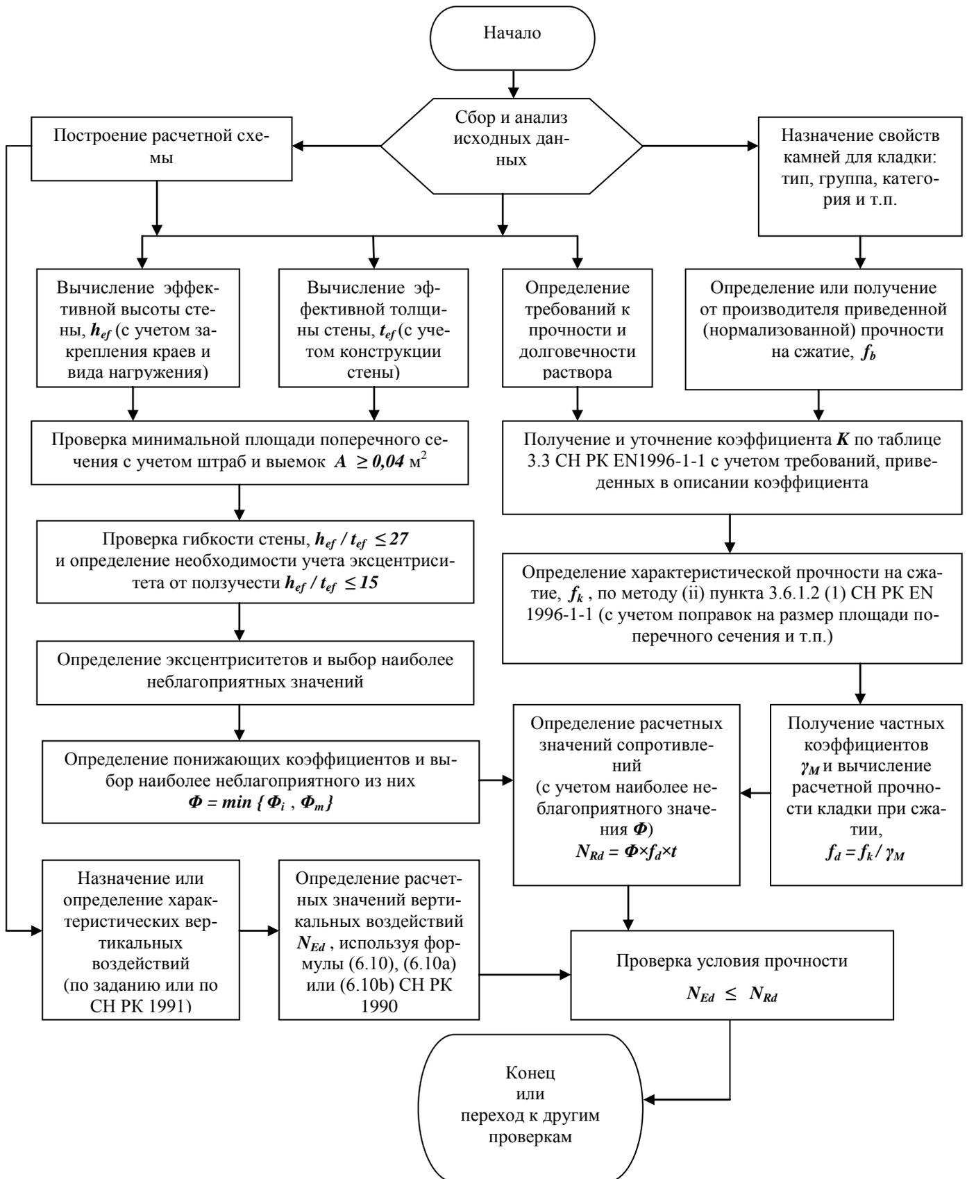
**Рисунок 9.1** Принципиальная блок-схема (алгоритм) расчета неармированной каменной кладки на вертикальные воздействия (расчет армированной кладки выполняется аналогично, с соответствующей заменой некоторых величин)
