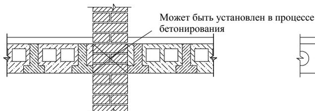
Сборные плиты перекрытия примыкающие к внутренней стене
