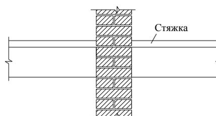
Балки и заполнение перекрытий примыкающие к внутренней стене
