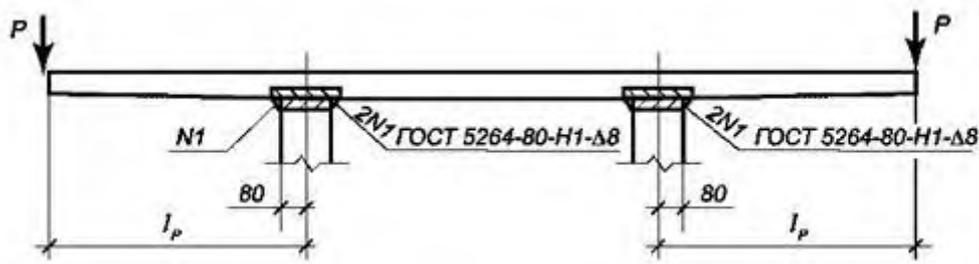
Рисунок 5 - Схема испытания ступеней типоразмера ЛСС 24
