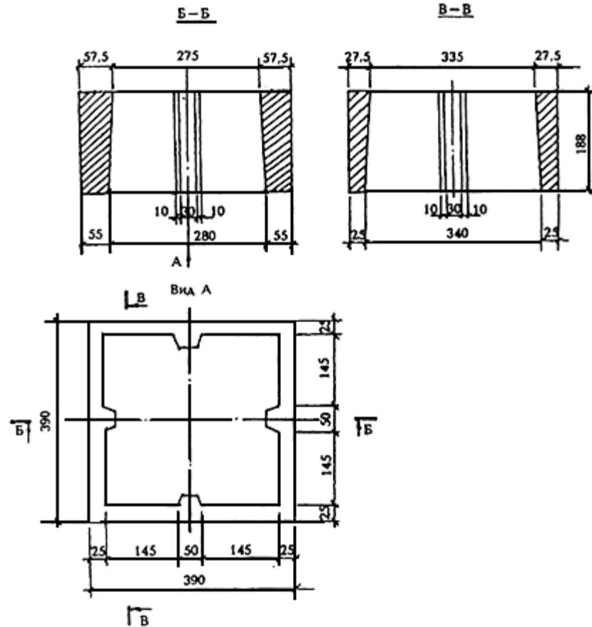
Рисунок Б.19 - Камень для дымовой трубы
