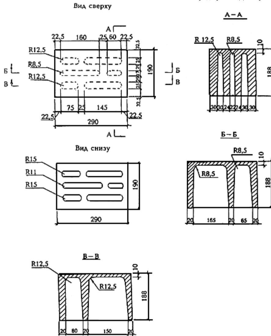
Рисунок Б.3 - Камень дополнительный стеновой рядовой (трехчетвертной)
