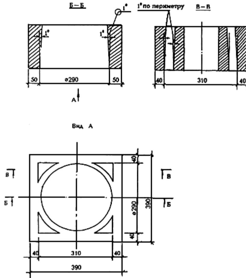
Рисунок Б.20 - Камень рядовой для вентиляционных каналов
