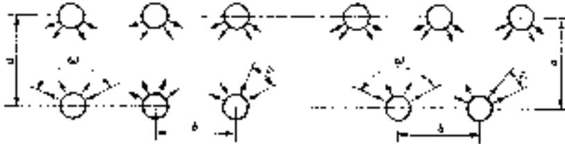
$\omega$  - угол охвата, град.;  $\tau$  - угол между оптическими осями, град.; a - ширина освещаемой площади, м; b - расстояние между мачтами, м.
