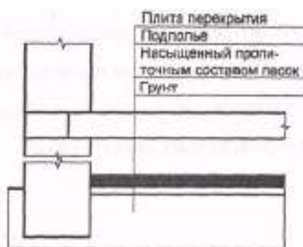
Рис. 1. Пропиточная противорадоновая изоляция грунтового пола подполья
